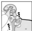
Εικ. 1 Αφαιρέστε το πώμα σφράγισης στερεώστε τη φύσιγγα προσαρτήστε στη συσκευή ανάμιξης
